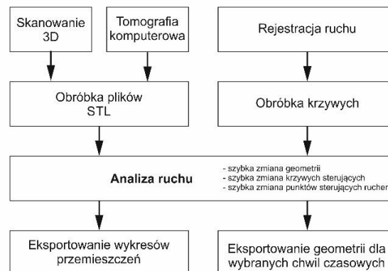
Rysunek.1. Schemat ideowy działania środowiska do analizy ruchu.
